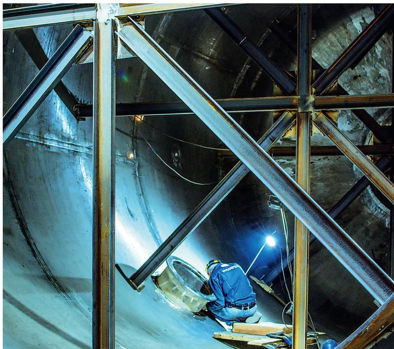
1. Коллектор пара — часть парогенератора, «Атоммаш»
