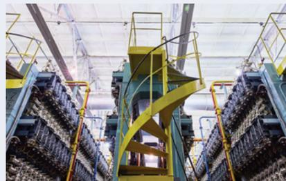
Уровень шума в машинном зале технологического цеха комбината, где одновременно вращаются сотни тысяч центрифуг, не превышает 80 дБ. Это сопоставимо с шумом уличного дорожного движения, звуком работающего офисного оборудования или бытового пылесоса.
