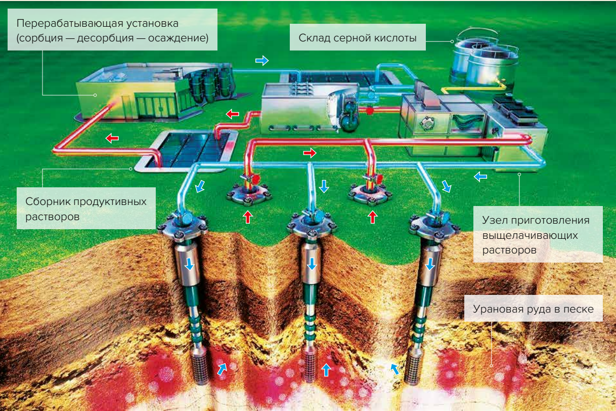
Рис. 2. Схема приготовления и движения выщелачивающих и продуктивных растворов
