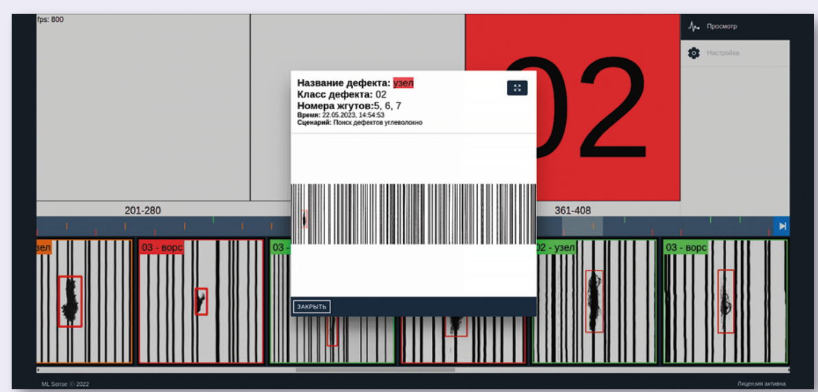
Интерфейс системы ML Sense показывает на экране киоска АРМ, что в красной зоне полотна обнаружен критический дефект в виде узла
