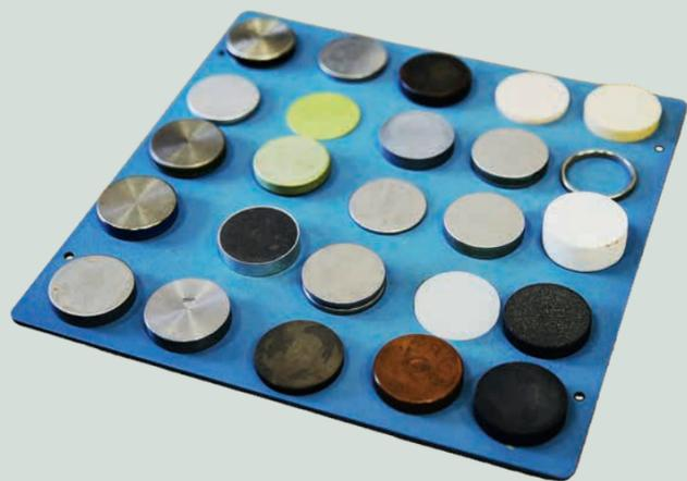
реактора, грубо, состоит из трех основных частей: конструкционные стали, теплоноситель и ядерный материал (не считая поглощающих материалов). И мы, как из конструктора леги, из сотен тысяч или даже миллионов таких блочков собираем ту композицию активной зоны, которую должны изучить.
